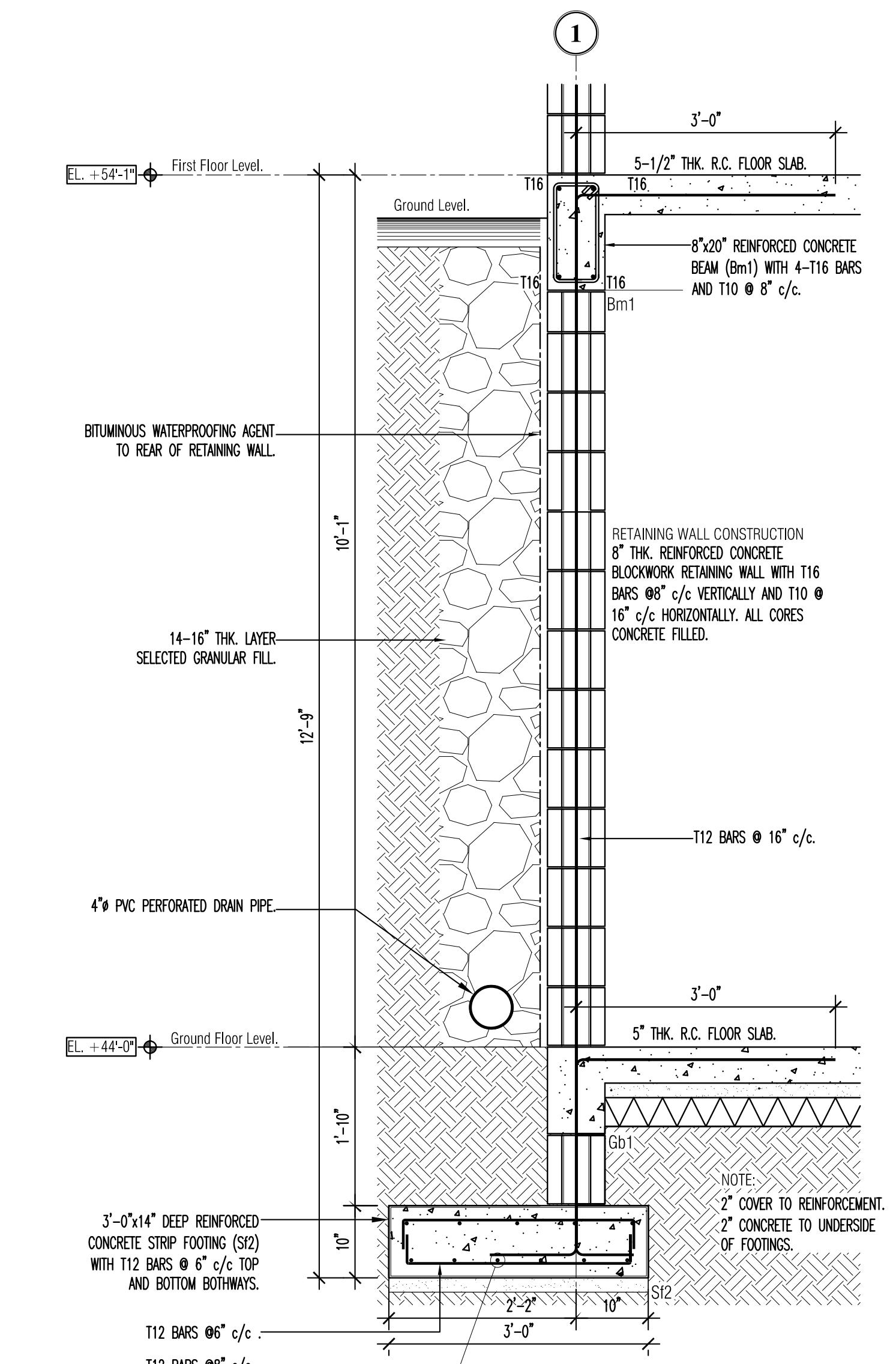
R.C. BLOCKWORK RETAINING WALL DETAIL
